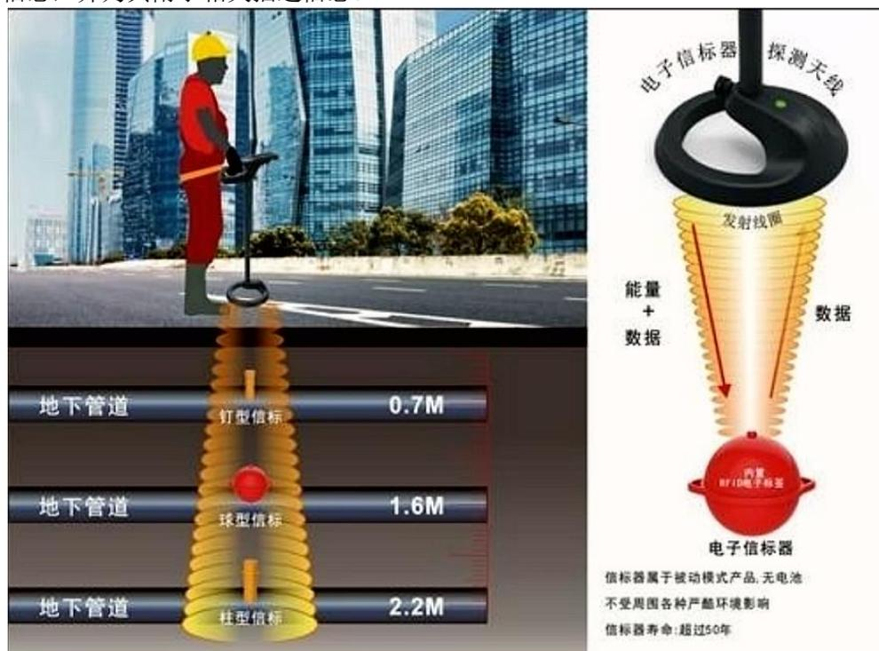
图B.1 固定信标定位法技术原理图
