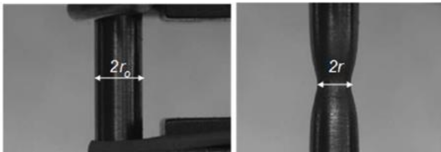
图 D.4 拉伸试样初始径向半径 r_0 和颈缩半径 r
